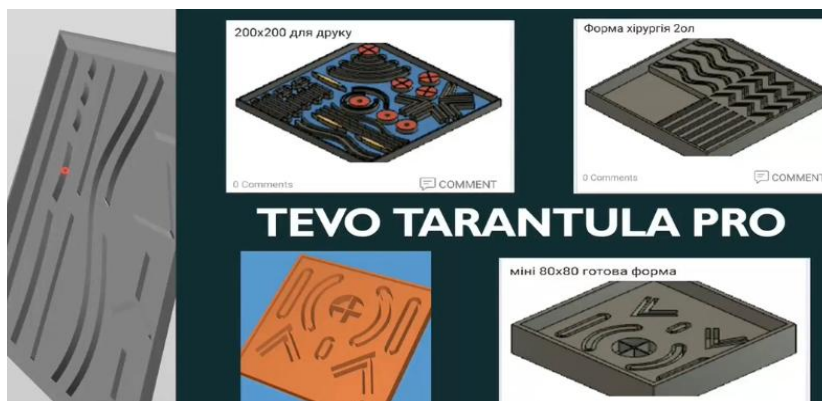
Рис. 1. Створення матриць для 3D-принтера за допомогою програми Autodesk Fusion для 3D принтера
